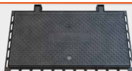
Tampa Articulada Telefone R - 2 TPFO Resistência B - 125 C - 250 D - 400
