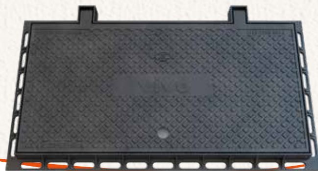
Tampa Articulada R1 - Telefone Resistência B - 125 C - 250
